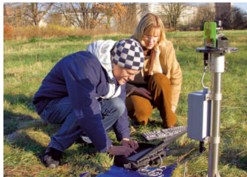
Auslesen der digitalen Niederschlagsmessung Readout of the digital precipitation measurement
