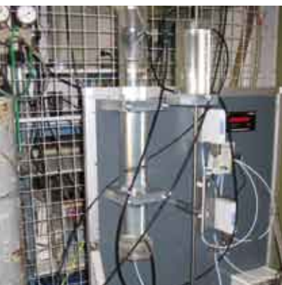
Anlage zur Ozonierung des Säulenzulaufs Ozonation plant for column inlet
