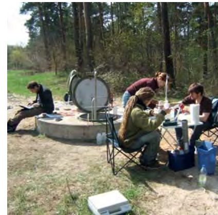
Tiefenorientierte Probenahme der FU Berlin Depth-oriented sampling by FU Berlin
